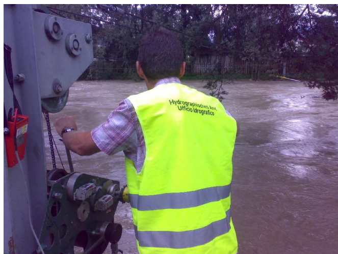
Figure 1/2. Misura di portata alla stazione idrometrica Aurino a S. Giorgio (a sinistra) durante l'evento di piena del 4 settembre e relativa curva di portata (a destra).
