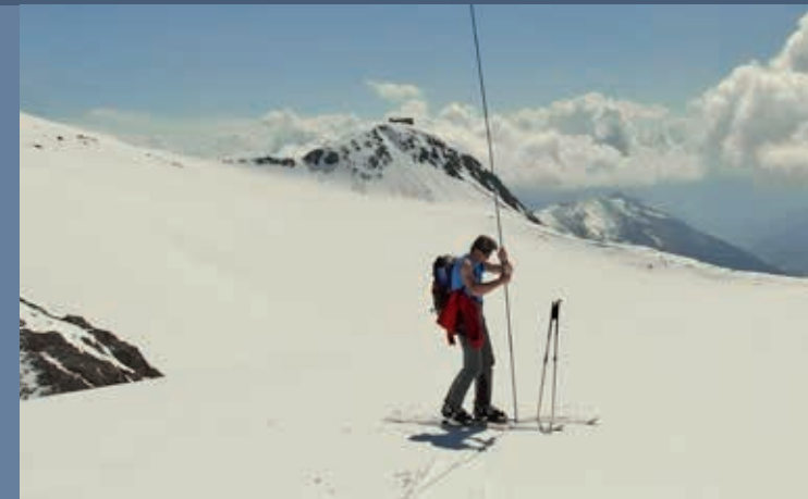
Sondierung zur Messung der Schneedeckenhöhe am Ende des Winters Sondaggio per la misura dell'altezza del manto nevoso alla fine dell'inverno
